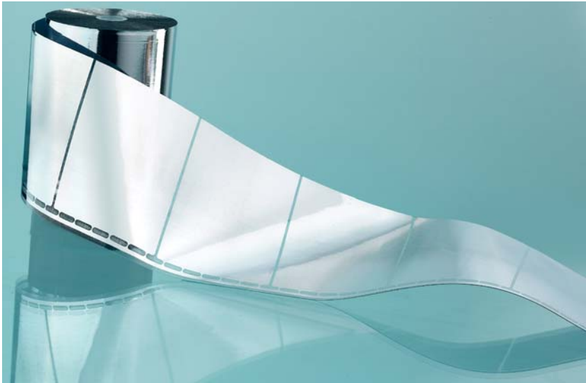
Bild 3. Der Spezialfilm ist so aufgebaut, dass die gesamte metallisierte Fläche des Kondensatorbelags in eine Vielzahl von Einzelflächen aufgeteilt ist und jede Einzelfläche über Sicherungsstege mit dem elektrischen Anschluss des Kondensatorwickels verbunden ist
