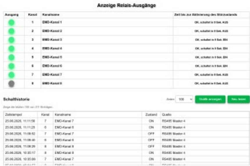
Abbildung 18: Relais-Ausgänge mit Schalthistorie
